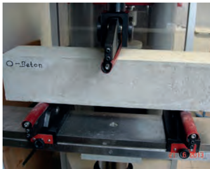
Проверка прочности на изгиб согласно EN 12390-5
