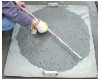
Проверка параметров удобоукладываемости согласно EN 12350-5
